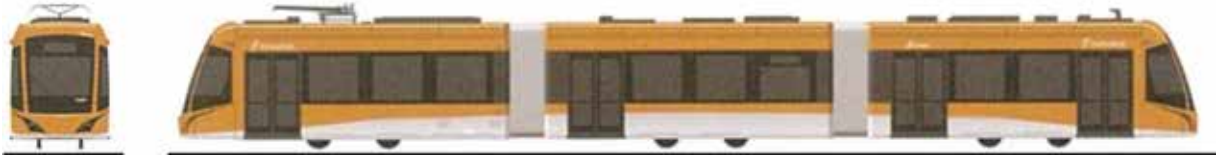
▲福井鉄道のFUKURAM(フクラム) 車両の長さ約27メートル、1編成は3車体接続で定員155人(最大輸送力232人) ※最大輸送力とは、実際に乗車できる最大人数の見込みで、定員数の150パーセント(新聞を広げて案に読める程度の混雑具合)で算出したもの
