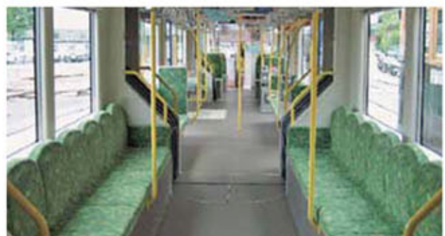
段差がない車内の床面(広島電鉄)
